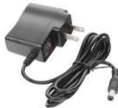
Fuente de poder de 5 Vcd regulado @ 1A; Voltaje de entrada de 100-240 Vca. Certificación de NOM
